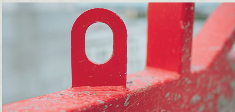
Mocowanie zawiesia dźwigu.
